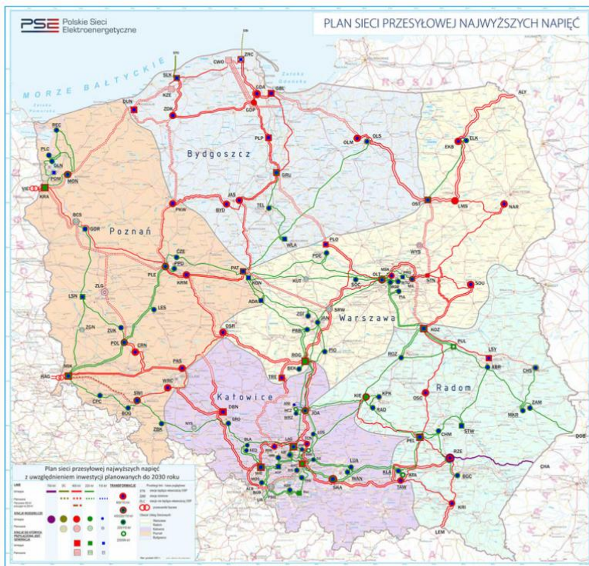
Rys. 10 Schemat Krajowego Systemu Przesyłowego (KSE) Źródło: PSE S.A.
